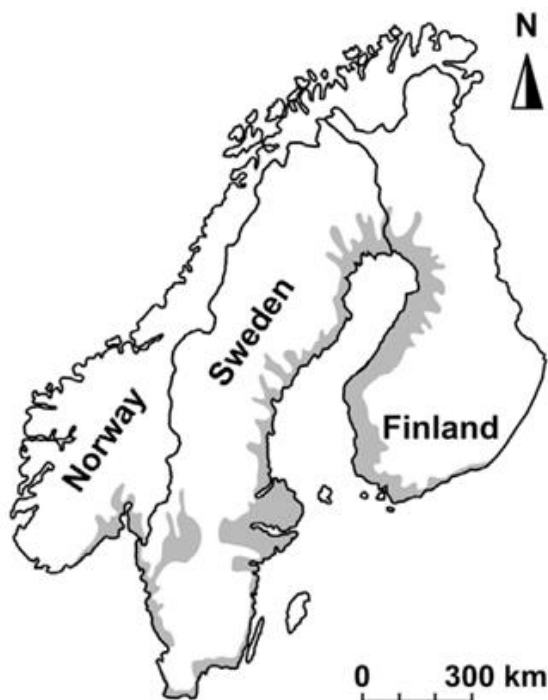
Figur 24. Potentiell förekomst av sulfidhaltiga massor i de nordiska länderna (Boman, Åström, & Fröjdö, 2008).
