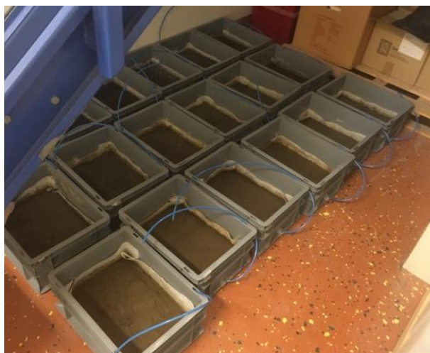
Figur 26. Lådorna där sulfidjord och kol eller kalciumkarbonat blandades i försöket att stabilisera jorden kemiskt (n=3). Foto från Kronsell och Flodin (2021).
