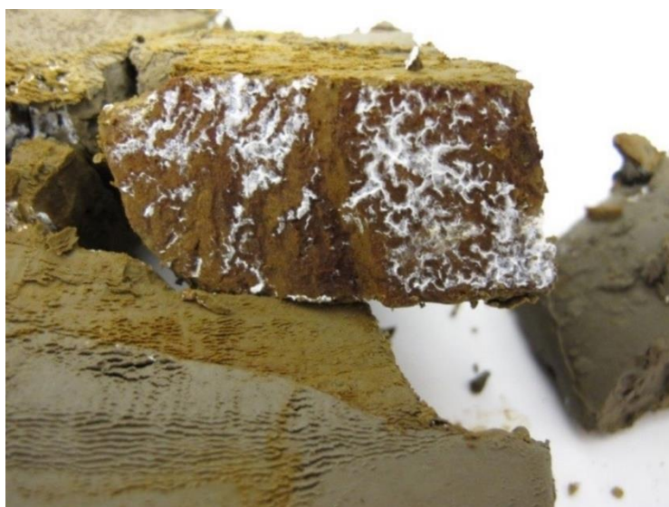
Figur 15. Kalksuspension sprider sig i spricksystemet. Bild: Thomas Andersson, från projektet PRECIKEM.
